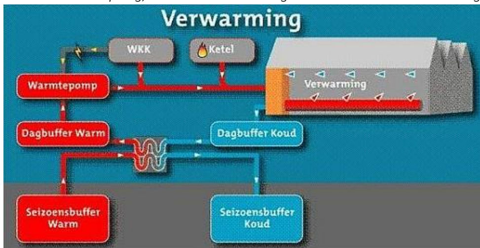
Illustratie principe van warmte-koude opslag via warmtepomp met bronnen-doublet (buffers) (figuren: Innogrow)
